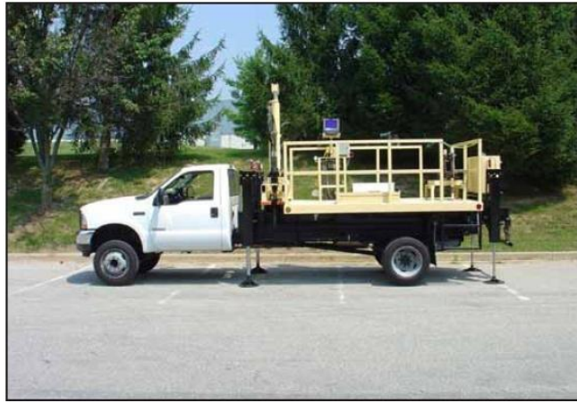
图 J.0.1 敞开式 CPTU 测试系统
